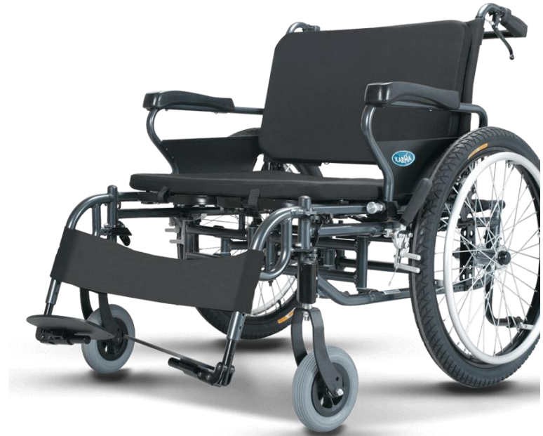
輪椅-C款（量身訂製型） 座寬22英吋以上 150公斤以上載重能力
